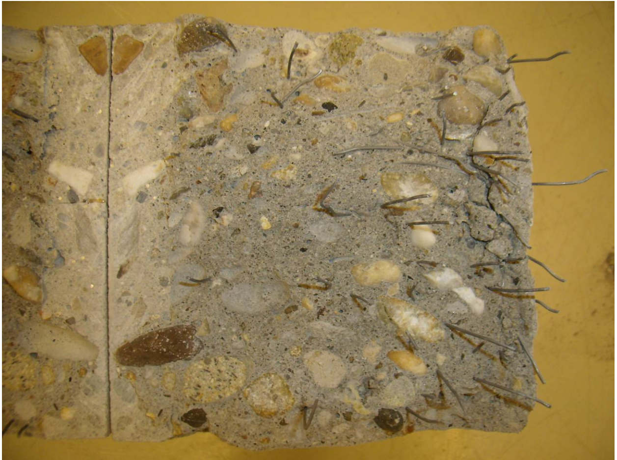
120905_042: szálak tömörülése a gerenda felső részén
